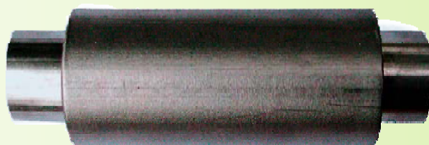
۲- لوله پله‌ای استوانه‌ای شکل داده شده با گوشه تیز (فولاد زنگ نزن ۳۰۴)
