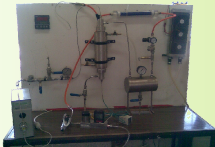
راکتور ساخته شده تولید هیدروژن از آلومینیوم و محلول سود در گروه پژوهشی فناوری پیل سوختی
