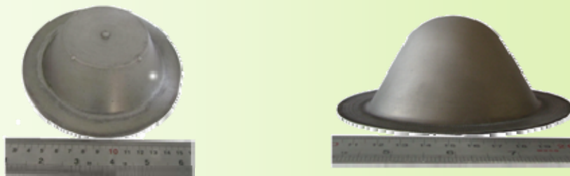
۸- قطعات مخروطی از جنس آلومینیوم، تولید شده با روش شکل‌دهی با گاز
