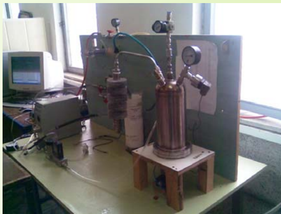
راکتور ساخته شده تولید هیدروژن از سدیم بورهیدرید در گروه پژوهشی فناوری پیل سوختی مزایای سیستم سدیم بورهیدرید
