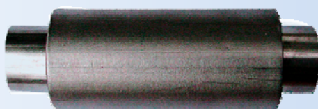
۲- لوله پله‌ای استوانه‌ای شکل داده شده با گوشه تیز (فولاد زنگ نزن ۳۰۴)
