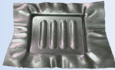
۵- قطعه آلومینیومی تولید شده بر روش هیدرو فرمینگ (آلیاژ آلومینیم سری ۶۰۰۰)
