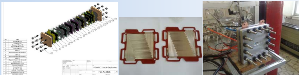
سلول پیل سوختی با صفحات بایپلار فلزی با راندمان بالا و درصد پرژ کم
