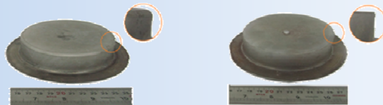
۷- قطعات استوانه‌ای از جنس آلومینیوم، تولید شده با روش شکل‌دهی با گاز
