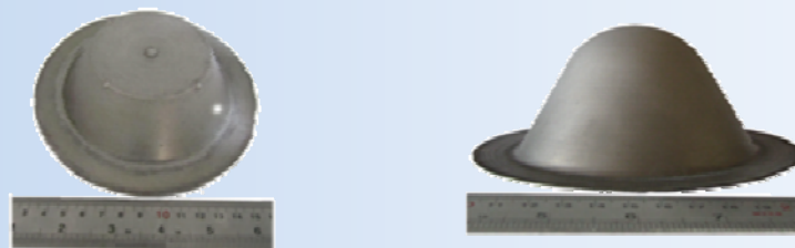
۸- قطعات مخروطی از جنس آلومینیوم، تولید شده با روش شکل‌دهی با گاز
