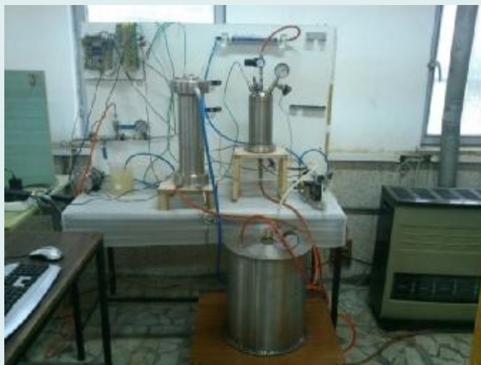
راکتور ساخته شده تولید هیدروژن از آلومینیوم و محلول سود
