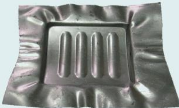
5- قطعه آلومینیومی تولید شده بر روش هیدرو فرمینگ (آلیاژ آلومینیم سری 6000)
