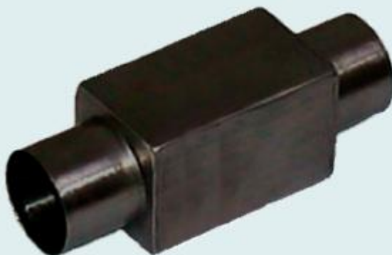
4- لوله پله‌ای مربعی با گوشه تیز، شکل داده شده (فولاد زنگ نزن 304)
