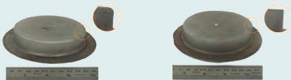
7- قطعات استوانه‌ای از جنس آلومینیوم، تولید شده با روش شکل‌دهی با گاز
