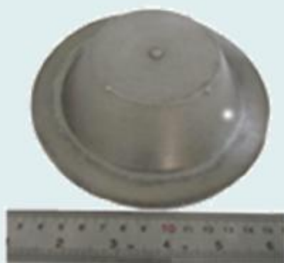
8- قطعات مخروطی از جنس آلومینیوم، تولید شده با روش شکل‌دهی با گاز
