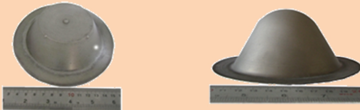
8- قطعات مخروطی از جنس آلومینیوم، تولید شده با روش شکل‌دهی با گاز
