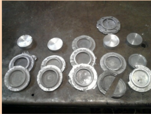
قطعات آهنگری شده از بیلت نیمه جامد
