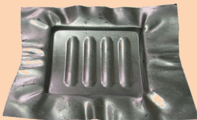
5- قطعه آلومینیمی تولید شده بروش هیدرو فرمینگ (آلیاژ آلومینیم سری 6000)
