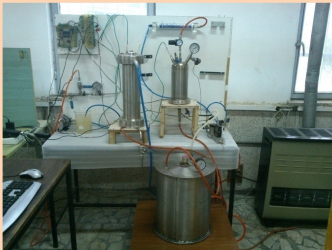
راکتور ساخته شده تولید هیدروژن از آلومینیوم و محلول سود در گروه پژوهشی فناوری پیل سوختی پلیمری
