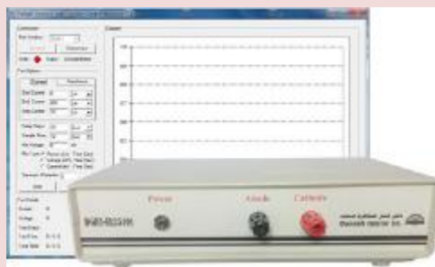
شکل 7-4 سافت و تجاری سازی دستگاه تست جریانی پیل سوختی میکروبی
