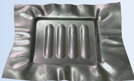
۵- قطعه آلومینیومی تولید شده بروش هیدرو فرمینگ (آلیاژ آلومینیم سری ۶۰۰۰)
