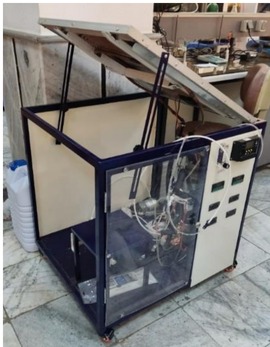
شکل: ساخت ستاپ آزمایشگاهی "آب شیرین کن تقطیر غشایی الکتروترمال خورشیدی"
